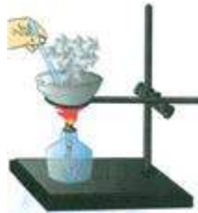
Мал. 54. Випарювання розчину
