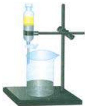
Мал. 52. Розділення суміші двох рідин, які не розчиняються одна в одній, у ділильній лійці
