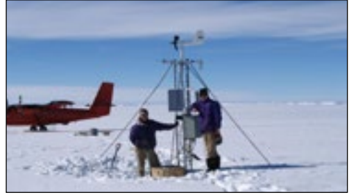
Мал. 2.184. Метеорологічні спостереження на Антарктиді з допомогою сучасної мобільної метеостанції
