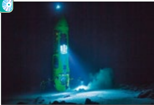
Мал. 3.18. Глибоководна сталева камера — батискаф на дні Маріанського жолоба (2012 рік)
