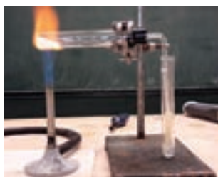
Мал. 48. Розкладання кальцій карбонату під час нагрівання
