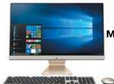
**Неттоп** — комп'ютер, системний блок якого прикріплений до монітора.
