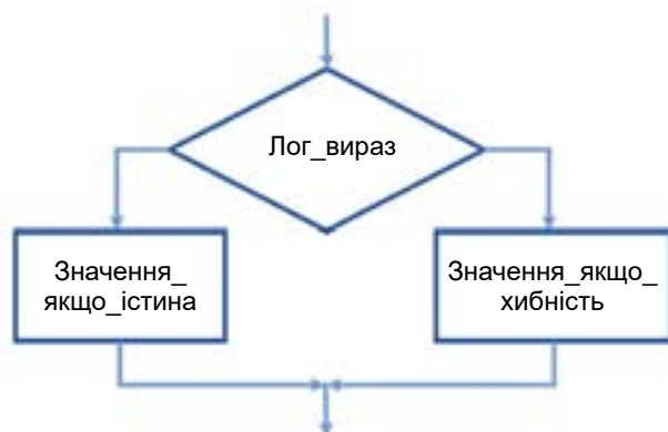
Рис. 13.1. Блок-схема виконання логічної функції IF
