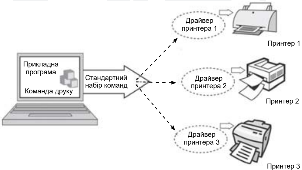
Рис. 2.2. Схема взаємодії пристроїв з використанням драйверів
