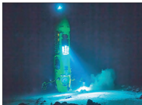
Мал. 5.6. Глибоководна сталева камера-батискаф на дні Маріанського жолоба Тихого океану (2012 рік)
